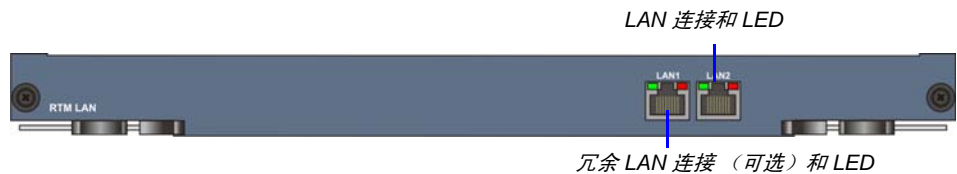
图 1-13 RMX 4000 RTM LAN 后面板布局
